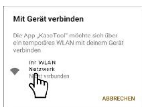
Abb. 70. Verbinden des Wechselrichters mit dem WLAN des Kunden
