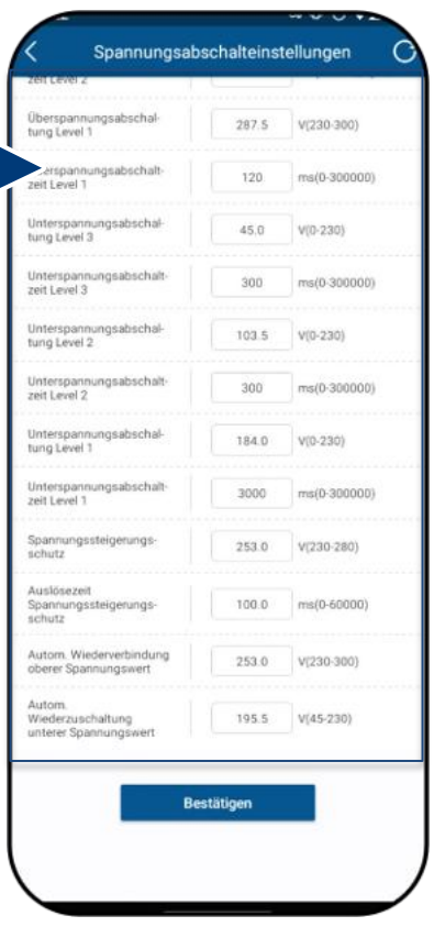
Abb. 139. Spannungsbereich und Abschaltzeiten festlegen
