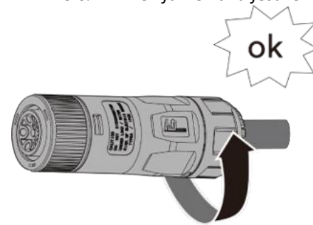
Abb. 17. L1-L3 & N+PE einführen und festziehen
