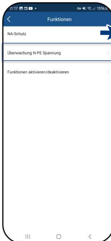
Abb. 108. Überwachung N-PE Spannung auswählen
