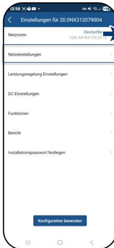
Abb. 110. Überwachung N-PE Spannung auswählen
