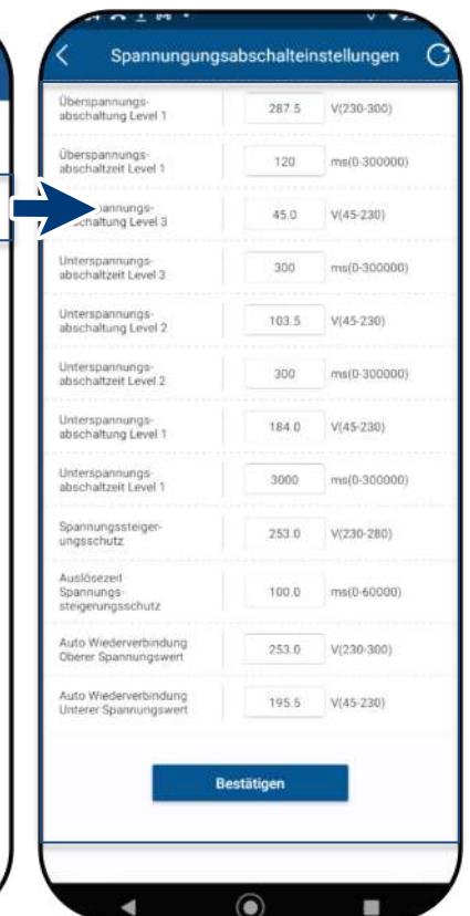
Abb. 115. Spannungsbereich und Abschaltzeiten definieren
