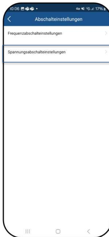
Abb. 114. Spannungsabschalt einstellungen auswählen
