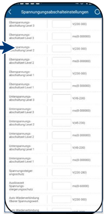
Abb. 119. Spannungsbereich und Abschaltzeiten festlegen
