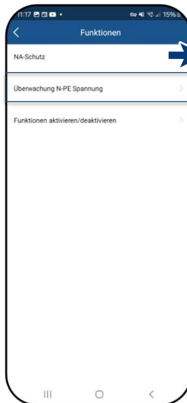
Abb. 112. Überwachung N-PE Spannung auswählen
