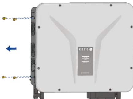
Abb. 184. Entfernen des Lüftermoduls
