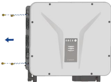
Fig. 184. Remove the fan module
