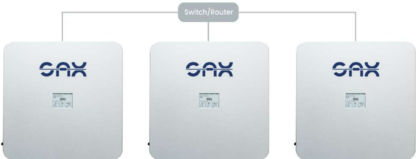
Abb. 59 Drei SAX Power Home (Plus) im Verbund
