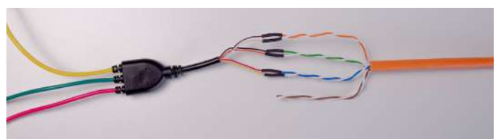
Abb. 45 Verlängerung der Messleitung 5 bis maximal 100 Meter
