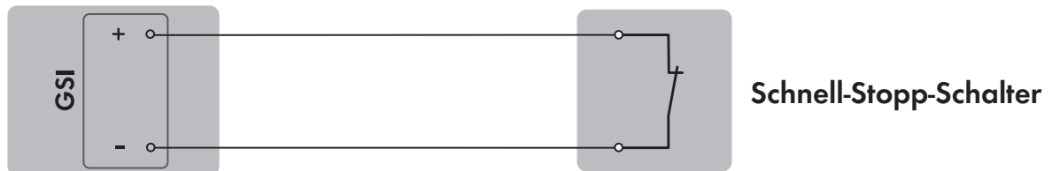
Abbildung 12: Anschluss eines Schalters für den Schnell-Stopp am digitalen Eingang GSI des Sunny Boy Smart Energy, der als System Manager konfiguriert werden soll
