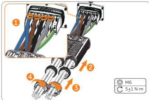
Abbildung 7-11 Das EPS-Kabel anschließen
