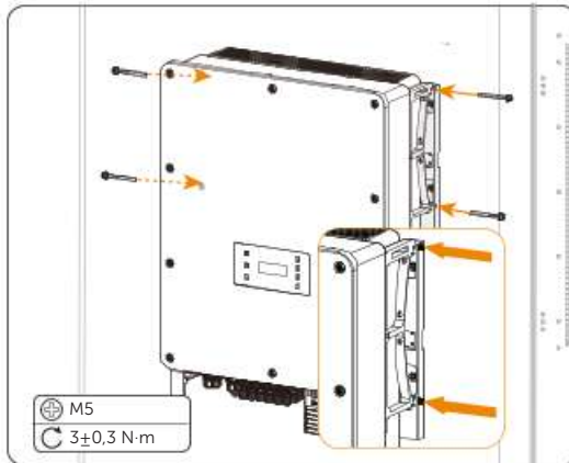
Abbildung 6-26 Den Wechselrichter sichern
