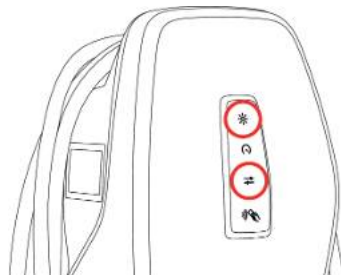
Obr. 13: Aktivování přístupového bodu (příklad)
