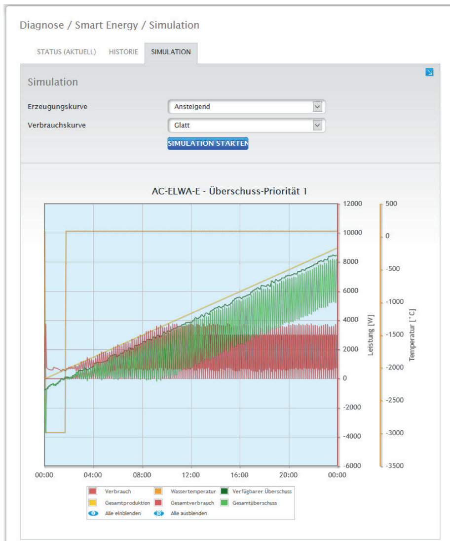
Abb.: Smart Energy - Simulation mit AC-ELWA-E - Überschuss-Priorität 1
